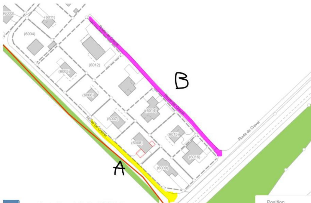
Le projet, partie A : 85 mètres, pas d'éclairage public, largeur de route inchangée. La route sera inclinée côté Yvonand avec une tranchée filtrante et un tuyau PVC.
